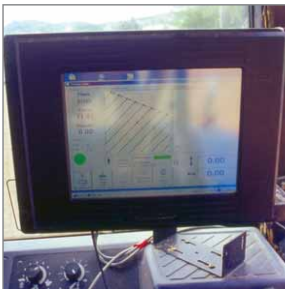
Fig. 5.32 - Computer installato sulla trattoria collegato al sistema G.P.S integrato.
