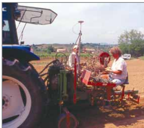
Fig. 5.33 - Trapiantatrice con l'innovativo sistema G.P.S. integrato. Si nota il rilevatore G.P.S mobile sulla trapiantatrice e la stazione differenziale posta all'inizio dell'appezzamento. La direzionalità della trattoria i punti di partenza e la distanza dei filari sarà regolata dal G.P.S.
