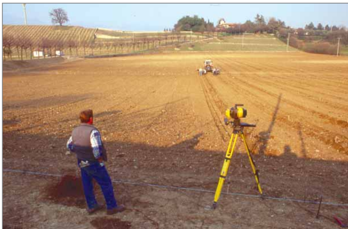
Fig. 5.34 - Normalmente la direzionalità dell'impianto delle barbatelle viene assicurata da un trasmettitore laser fisso e un ricevitore posto sulla trattoria. In automatico la trapiantatrice è in grado di spostarsi e riposizionarsi sulla fila mantenendo sempre l'allineamento iniziale.
