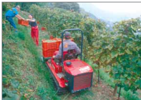
Fig. 5.17 - Con ripiani di 160-180 cm è possibile l'utilizzo di trattori cingolati larghi circa un metro e si possono meccanizzare tutte le operazioni colturali ad esclusione della vendemmia.
