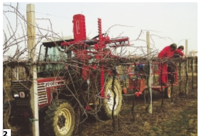
Foto 2 - Cantiere di potatura costituito dalla stessa macchina con due rifinitori su carrello trainato
