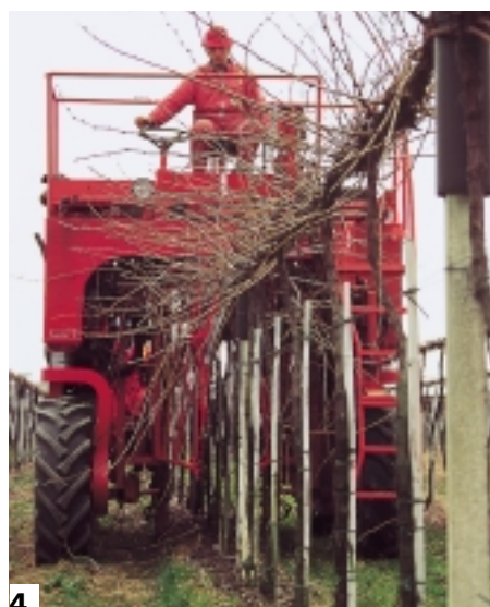
Foto 3 - Vista posteriore della macchina polivalente Trinova con due rifinitori posti su due piattaforme al lavoro su cordone libero speronato.
