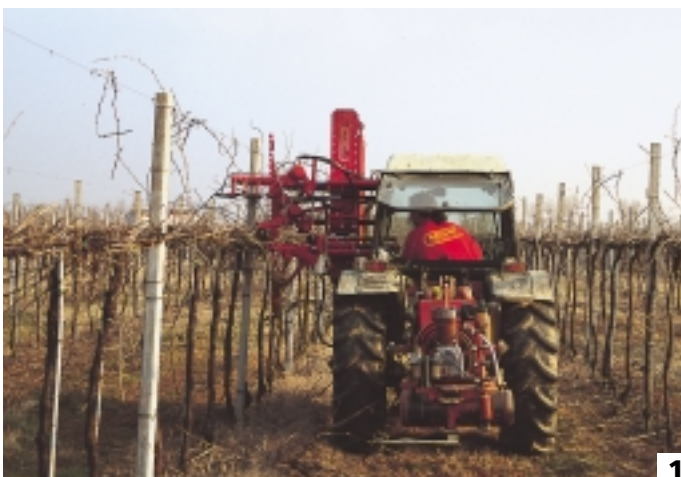
Foto 1 - Cantiere di potatura composto solo dalla potatrice Tanesini al lavoro su cordone speronato non rifinito
